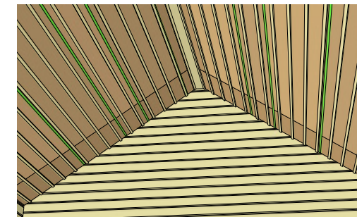
12. Kiinnitä päätyseinällä riippuva ilmansulku kattopalkkeihin sekä asenna koolausrimat paikoilleen.
